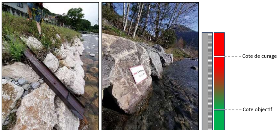
Figure 52 : Types de repères d'engravement.
